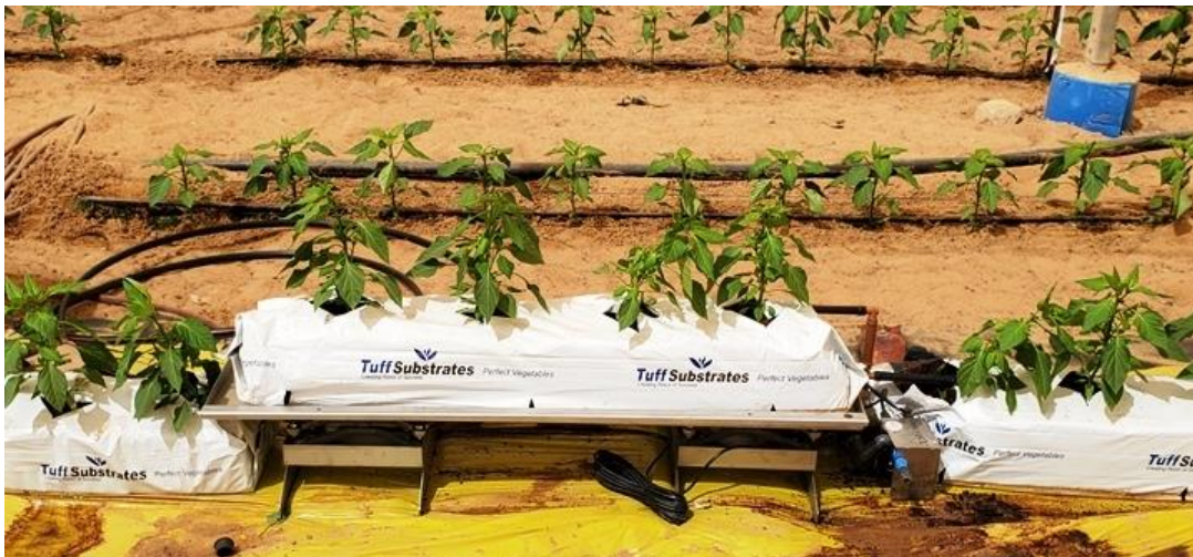
איור 4: ניסוי פלפל סוויט בייט (WLS2042) ע"ג מצעים מנותקים מסוג קוקוס "מארז" עטוף בפלסטיק (27 ל'), שהוצב על ליזימטר משקלי של חברת פסקל. (שתילת אביב 2022).
